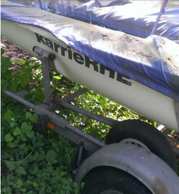
**Entdeckt auf dem Bootslager beim AKJS. Durch den Regen ist der 420er bis zur Kante voll gelaufen und wurde dadurch so schwer, dass an den Auflagen des Trailers der Rumpf eingedrückt wurde. So entsteht ein „KarrierHE-Knick“.**
